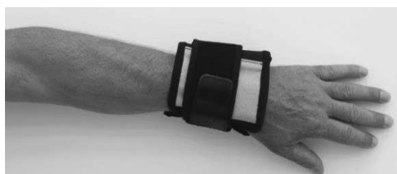
Exemple de positionnement avec solénoïdes opposés
